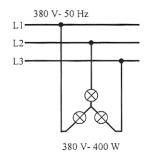
b) Conexión triángulo
