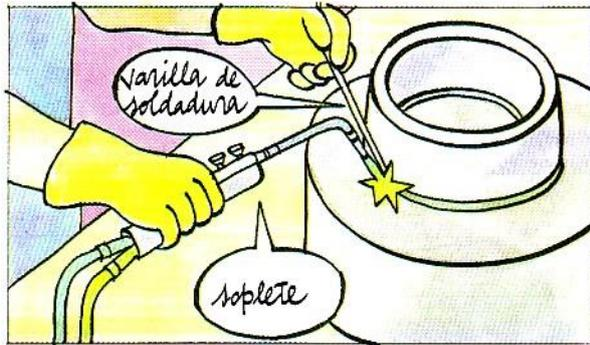
Con la **soldadura autógena** añadimos un poco de metal en la zona de unión que, mediante una llama, se fundirá con las piezas en dicha zona.
